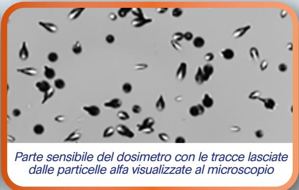
*Parte sensibile del dosimetro con le tracce lasciate dalle particelle alfa visualizzate al microscopio*
